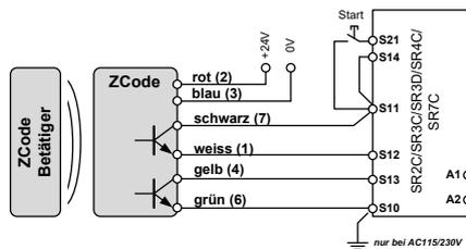
Abb. 5: Einzelanschluss eines ZCodes an ein ZANDER SR<sup>®</sup>C<sup>®</sup> (bis Kategorie 4, PL e)
